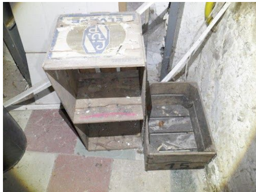
door kleine klopkever aangetast materiaal.
