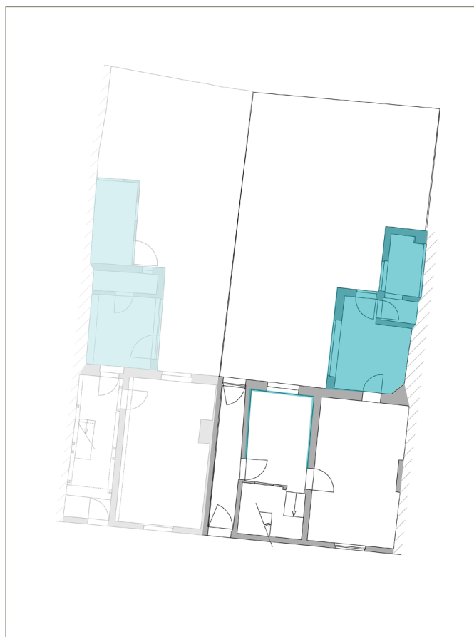
afb. 14 Storende elementen gelijkvloerse verdieping: gelijkvloerse aanbouw, schouw tegen rechter zijgevel met bakstenen rookkanaal tegen buitengevel
