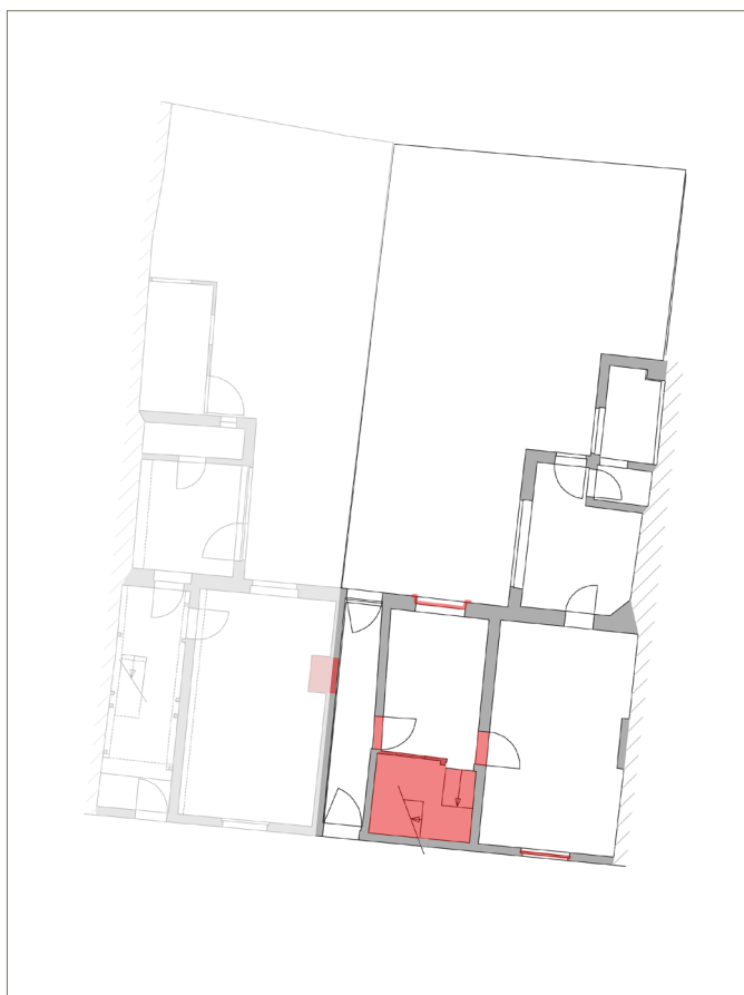
afb. 11 Historisch waardevolle elementen gelijkvloerse verdieping: houten paneeldeuren, opkamer boven kelder met houten plankenvloer en -wand.
